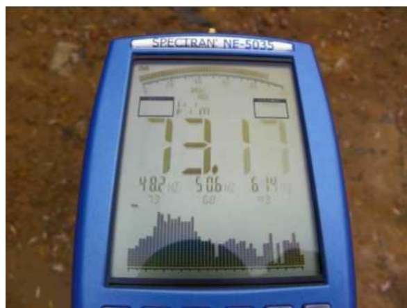
Ryc.20 Pomiar składowej elektrycznej (na lewo) i składowej magnetycznej (na prawo) w punkcie pomiarowym zlokalizowanym w odległości ok 5m od transformatora 15kV
