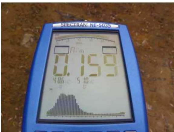
Ryc.20 Pomiar składowej elektrycznej (na lewo) i składowej magnetycznej (na prawo) w punkcie pomiarowym zlokalizowanym w odległości ok 5m od transformatora 15kV
